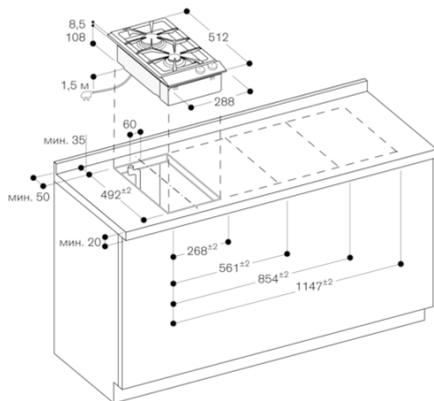
Минимальное расстояние от выреза прибора до боковой стенки 150 мм.
